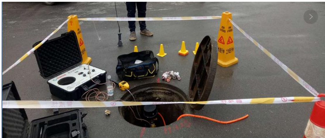
图 2-3 主动声源探测仪安装图
